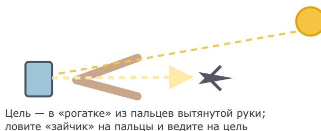
Рис. 14.1. Наведение солнечного зайчика через прицеливание пальцами
