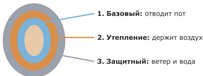
Рис. 12.1. Три слоя одежды: базовый (термобелье, синтетика/шерсть — НЕ хлопок), утепление (флис, свитер, пух), защитный (мембрана, дождевик). Тепло держит не ткань, а воздух между слоями
