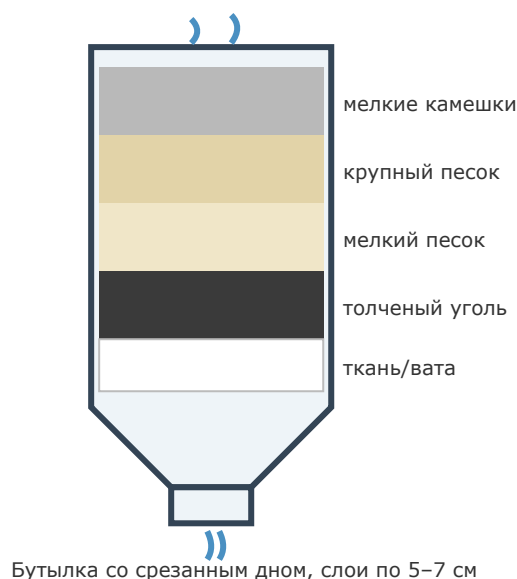
Рис. 8.1. Самодельный фильтр из бутылки. Уголь — из прогоревшего костра (не угли!)
